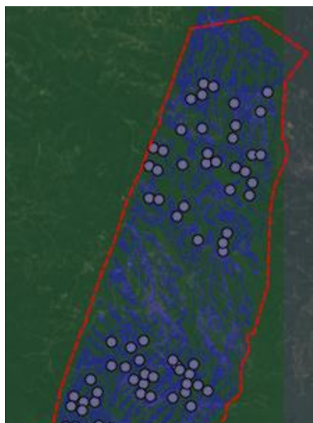
Σχήμα 5 Σημεία επίγειων μετρήσεων στις προσανατολισμένες επιφάνειες προς τους αισθητήρες των συστημάτων SAR
